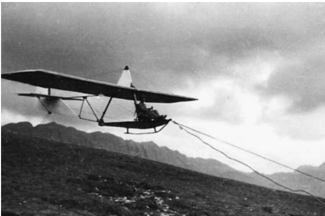
En la imagen se puede n ver los cables que lanzaban el planeador enganchado a uno de los aviones lanzadores.
